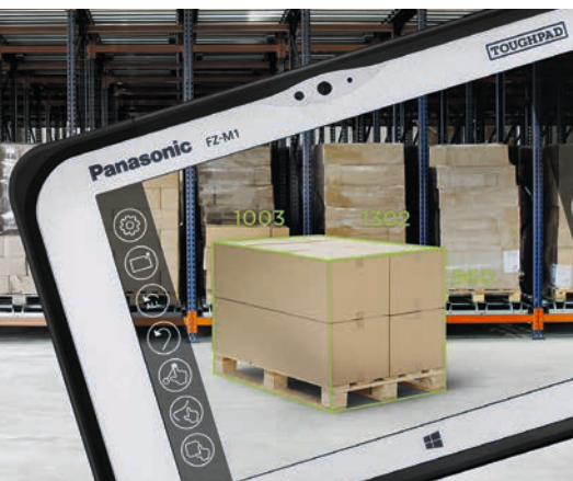
Die optionale integrierbare Real-Sense-Technologie ermöglicht die 3-D-Vermessung von Packstücken und Lagerfläche.
